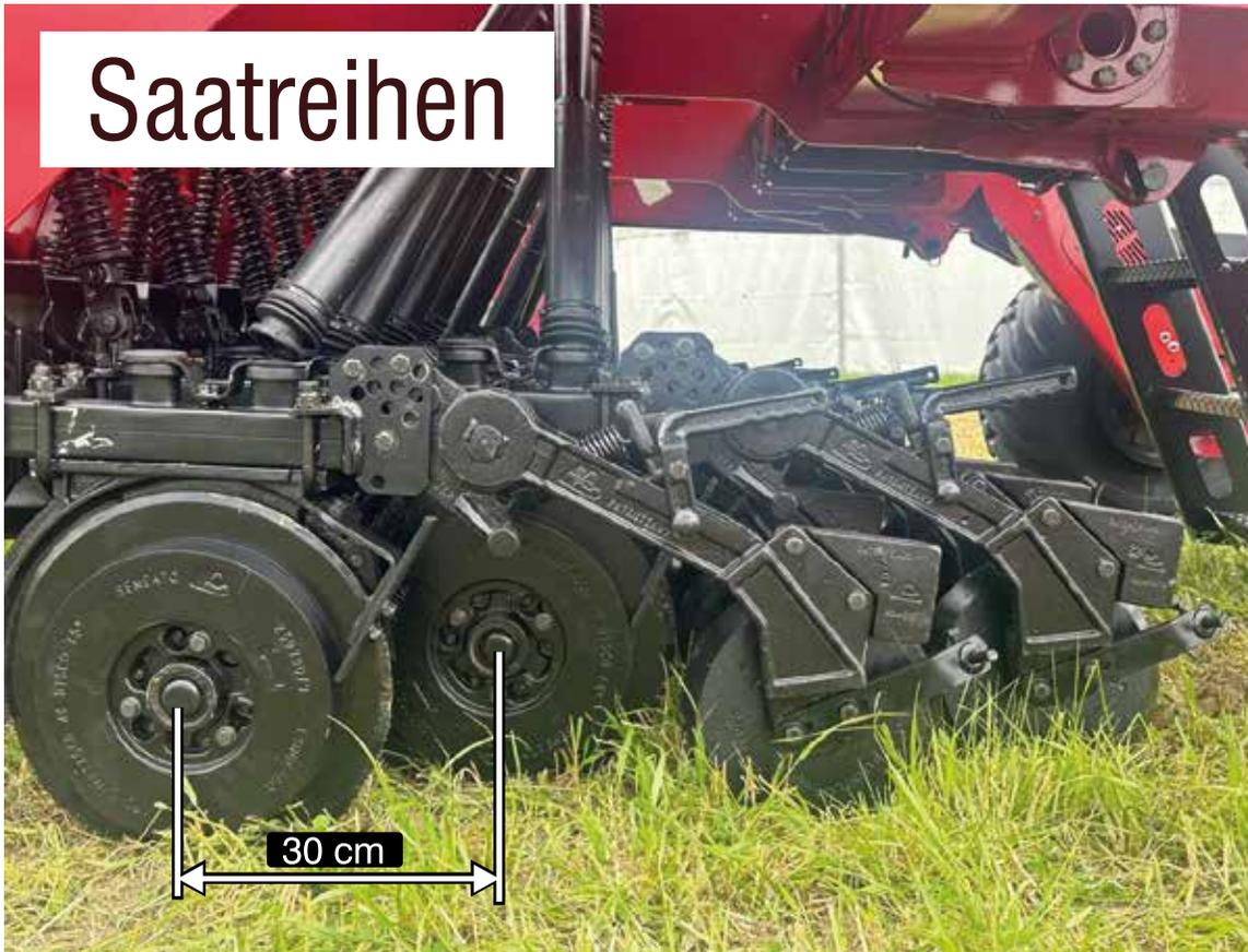
Die Saatreihen sind mit einer robusten Bauweise ausgestattet, deren Wirkung besonders bei Bodenunebenheiten spürbar wird. Dank eines speziellen Federsystems und zwei Hydraulikzylindern, mit denen die Bewegung der Saatelemente kontrolliert wird, verfügt der Sämeelement über eine starke Eindringkraft in den Boden.
