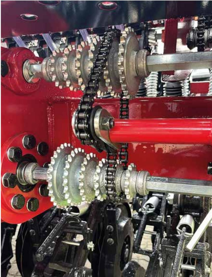
Das Kettenradgetriebe bietet eine Reihe von Kombinationsmöglichkeiten, um sowohl Empfehlungen als auch technische Anforderungen gerecht zu werden.
