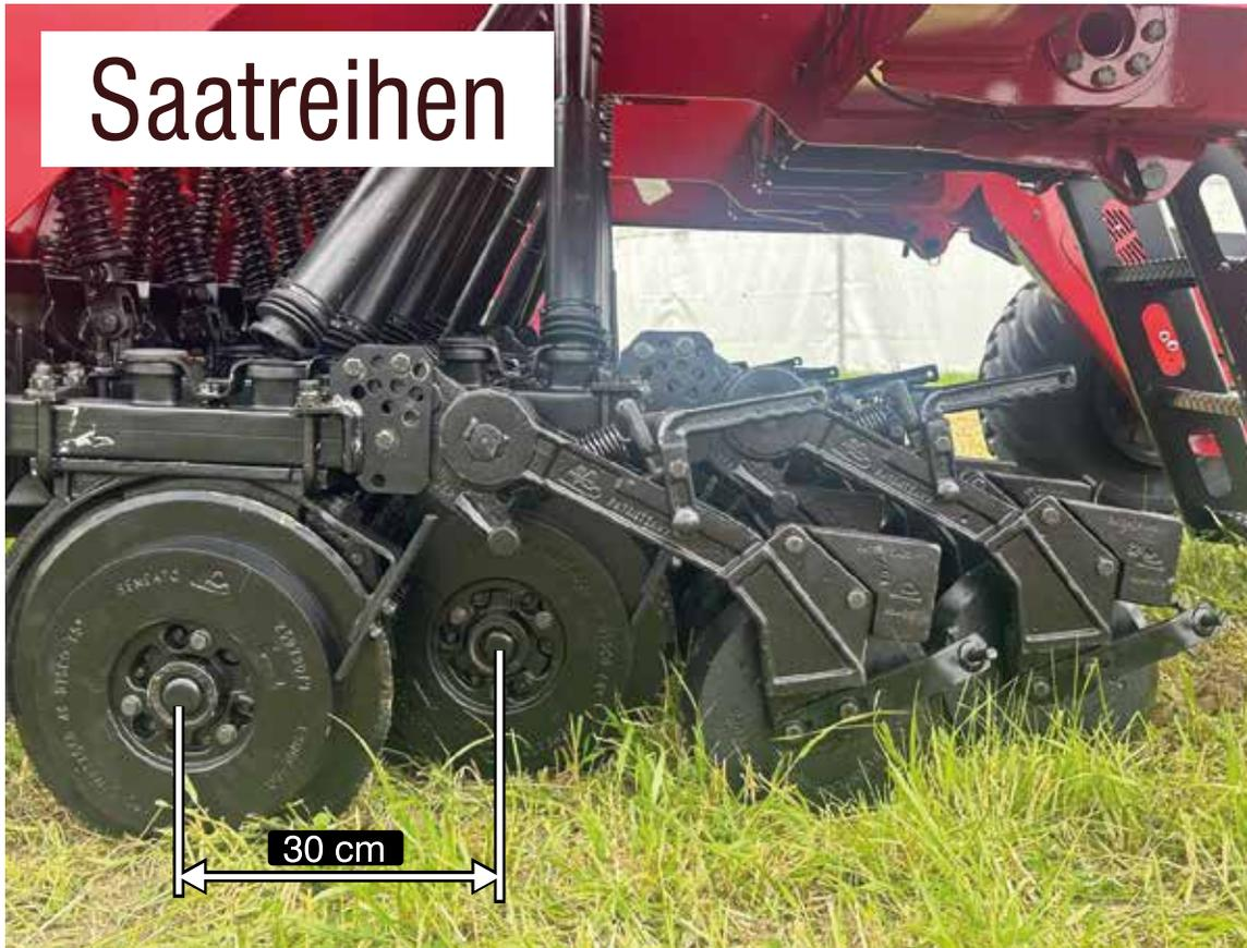
Die Saatreihen sind mit einer robusten Bauweise ausgestattet, deren Wirkung besonders bei Bodenunebenheiten spürbar wird. Dank eines speziellen Federsystems und zwei Hydraulikzylindern, mit denen die Bewegung der Saatelemente kontrolliert wird, verfügt der Sämechanismus über eine starke Eindringkraft in den Boden.
