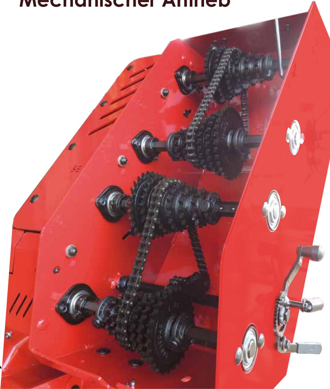
Das Kettenradgetriebe bietet eine Reihe von Kombinationsmöglichkeiten, um sowohl Empfehlungen als auch technische Anforderungen gerecht zu werden.
